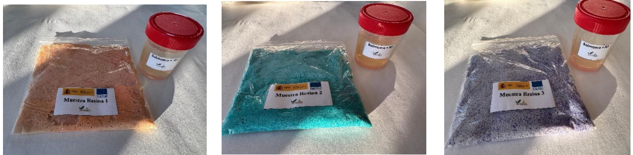
Figura 2, 3 y 4 izquierda-derecha: muestra resina1 y salmuera obtenida, resina dos y salmuera, resina 3 y salmuera.
